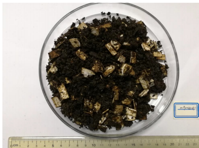
图 7 试验前 M190022-01 与堆肥混合后的照片 (样品组反应容器 1)
