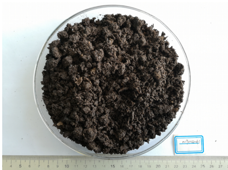
图 8 试验后 (第 154 天) M190022-01 与堆肥混合的照片 (样品组反应容器 1)
